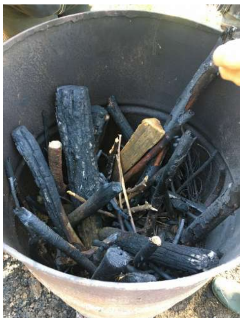
5. Après 3h de combustion, le bois devient biochar. Laisser refroidir la nuit.
