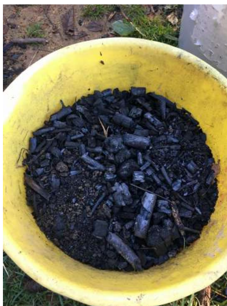
6. Rendement : pour 200L de bois, on obtient à peu près 40L de charbon
