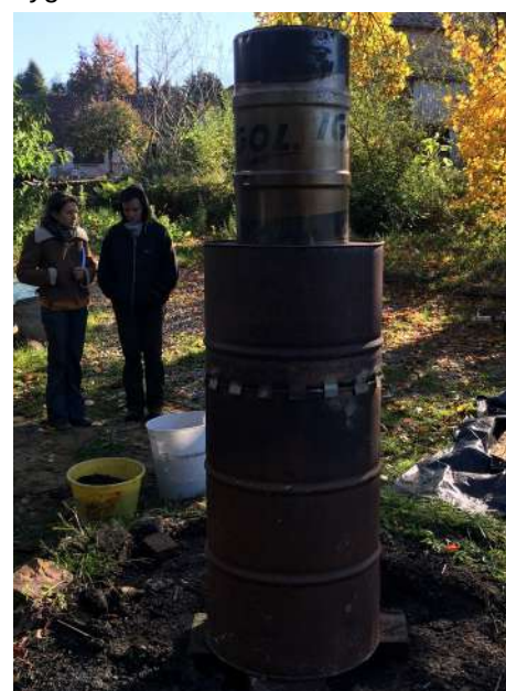
3. Allumer sans refermer le couvercle pour faire commencer la combustion 4. Au bout d'1h à 1h30, refermer le couvercle pour commencer la combustion anaérobie
