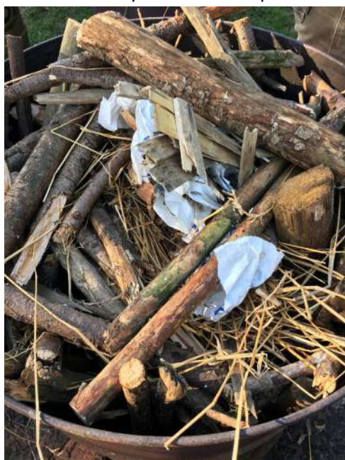
1. Remplir le bidon avec des branches épaisses au fond, plus fines en haut
